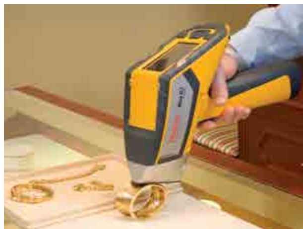
Анализ ювелирных изделий с помощью анализатора драгметаллов Niton XL-2.
