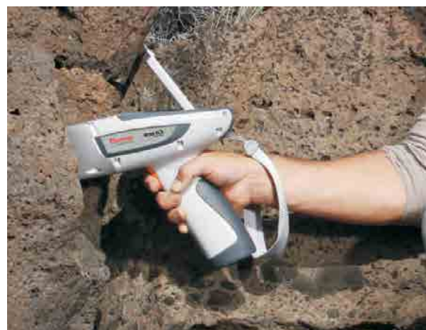
Niton XL-3t GOLDD – идеальный инструмент для мгновенного химического анализа в полевых условиях.
