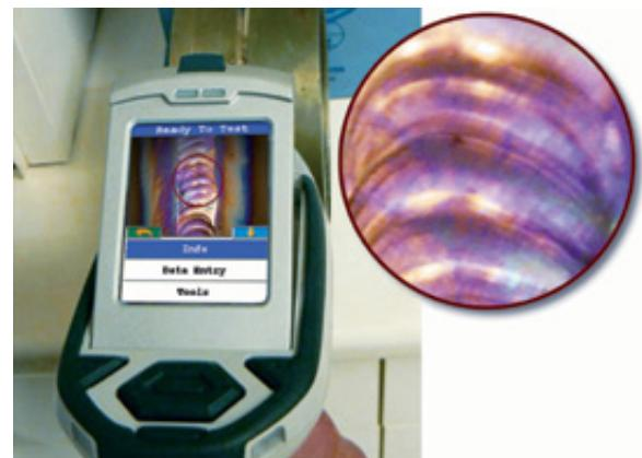
WeldSpot (ВелдСпот) - революционная опция, позволяющая сфокусировать рентгеновский пучок в пятно диаметром 3 мм, для более точного анализа материала элементов сварного шва. Включает систему точечной фокусировки и встроенную миниатюрную видеокамеру
