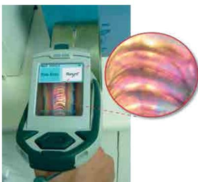
Встроенная CCD видеокамера и функция точечной фокусировки позволяют провести анализ именно нужного участка образца и сохранить его изображение вместе с результатами анализа.
